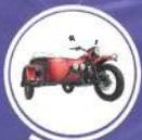
Véhicule de la catégorie L3e équipé d'un side-car pouvant transporter au plus, quatre personnes y compris le conducteur dont deux au plus dans le side-car.
