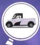
Véhicule à moteur à quatre roues n'appartenant pas à la catégorie L6e dont le poids à vide n'excède pas 600 kilogrammes pour les quadricycles affectés au transport de marchandises et 450 kilogrammes pour les quadricycles destinés au transport de personnes.
