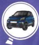
Véhicule à moteur à quatre roues, dont le poids à vide n'excède pas 425 kg, la vitesse maximale égale par construction est égale ou supérieure à 6 km/h et ne dépasse pas 45 km/h et la cylindrée n'excède pas 50 cm<sup>3</sup> pour les moteurs à combustion interne à allumage commandé, 500 cm<sup>3</sup> pour les moteurs à combustion interne à allumage par compression et conçu pour transporter au plus deux personnes y compris le conducteur.
